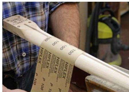
Abb. 8: Die Raspel- und Feilspuren werden mit einem langen Stück Schleifpapier beigearbeitet
