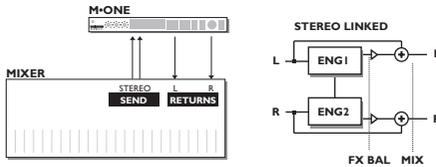
Bei diesem Routing werden die Effektparameter beider Engines verkoppelt, so dass diese denselben Effekt erzeugen. Der rechte Ein- und Ausgang wird für Engine 1 verwendet, der linke für Engine 2. Bei diesem Routing werden die für Engine 1 vorgenommenen Einstellungen automatisch für Engine 2 übernommen.
