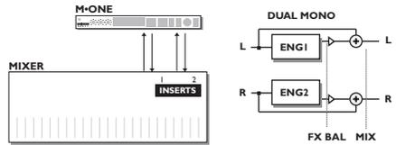
Bei diesem Routing sind beide Engines völlig unabhängig voneinander als Mono-Effektgeräte. Der rechte Ein- und Ausgang wird für Engine 1 verwendet, der linke für Engine 2.
