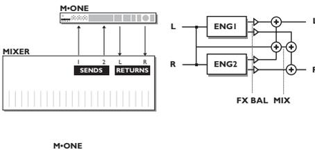
Dieses Routing fasst beide Eingänge zusammen und speist beide Engines mit diesem zusammengefassten Signal. Das unbearbeitete Signal wird über den Mix-Parameter dann wieder mit den beiden Effektsignalen gemischt
