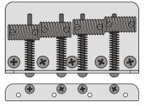
1959 - 1969 Precision Bass Steg Saitenreiter aus Gewindestangen (größere Steigung), größerer Radius am Haltebech der Einstellschrauben
