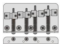
2005 - 2011 P- und J-Bass Steg Längere Einstellschraube für D- und G-Saite, Madenschrauben zur Höheneinstellung
