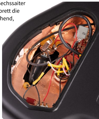
Sauber abgeschirmtes E-Fach mit Eingangsbuchse und akurater Verkabelung
