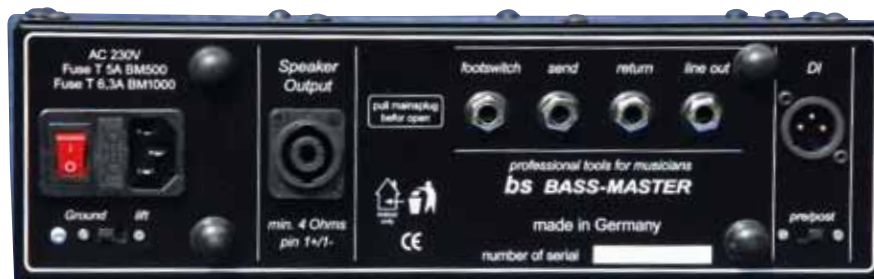
Die Anschlüsse auf der Rückseite: Lautsprecher-Ausgang, Fußschalter, Effekt-Loop, Line- und DI-Out (v.l.)
