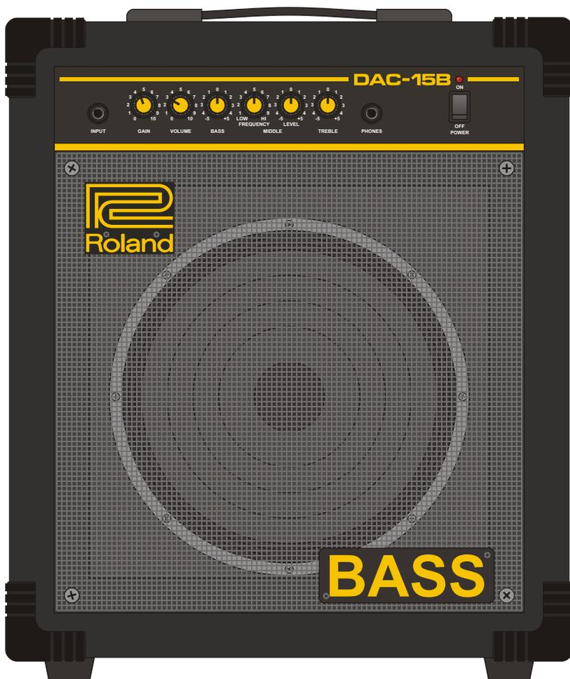
Die Leistung wird fälschlicherweise manchmal mit 20 Watt angegeben. Das ist jedoch sein Verbrauch. Die Leistung betrug - wie der Name sagt - 15 Watt. Das einzige, was man über den DAC-15B wohl sagen kann: Ein netter kleiner Übungsverstärker. Der DAC-15B wurde bis Anfang 1991 produziert.
